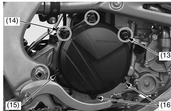
(13) arandela (nueva) (14) tornillos A de la tapa del embrague (15) tornillo B de la tapa del embrague (16) tornillos C de la tapa del embrague
