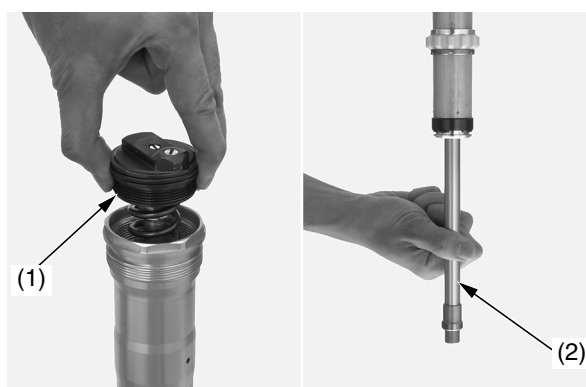
(1) conjunto de la tapa de la horquilla (2) barra del pistón del amortiguador de la horquilla
