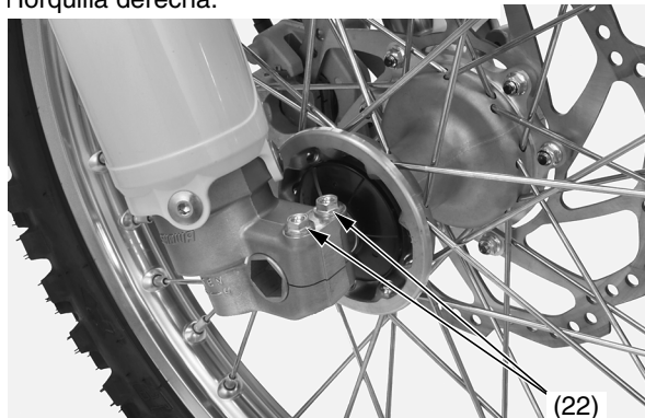
(22) pernos de fijación del eje derecho
