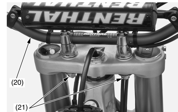
(20) manillar (21) gomas de montaje, arandelas y tuercas del soporte inferior del manillar
