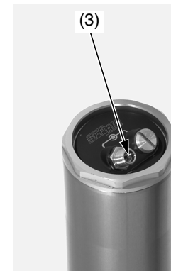
(3) válvulas de aire (4) centro de la válvula de aire de la cámara de equilibrio
