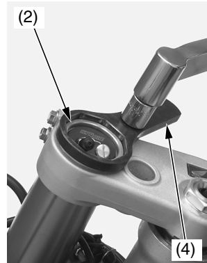
(2) unidad de cilindro de aire (3) amortiguador de la horquilla (4) llave de contratuercas
