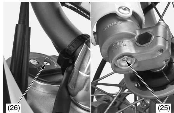
(25) ajustador de la amortiguación de expansión (26) ajustador de la amortiguación de compresión
