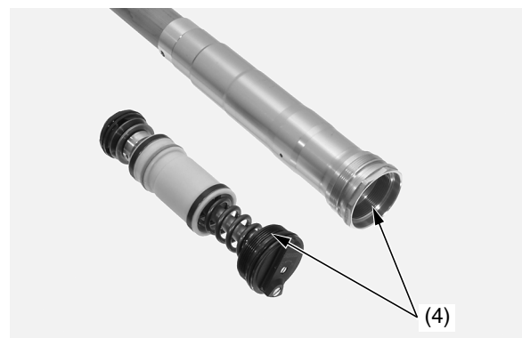
(4) tapa de la horquilla y roscas del amortiguador de la horquilla
