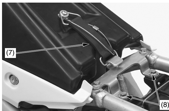
(7) banda del depósito de combustible (8) pernos de montaje del filtro de aire
