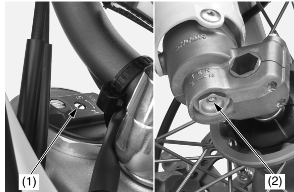
(1) ajustador de la amortiguación de compresión (2) ajustador de la amortiguación de expansión
