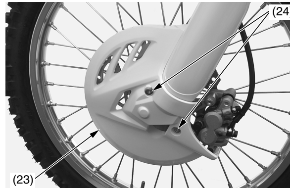
(23) cubierta del disco (24) pernos de cabeza hueca de la cubierta del disco
