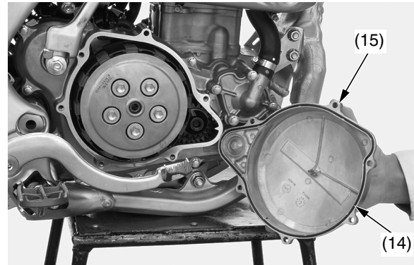
(14) junta tórica (nueva) (15) cubierta del embrague
