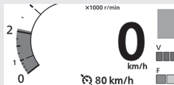
Velocidad programada del control de cruceo
