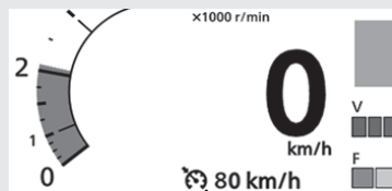
Velocidad programada del control de crucero
