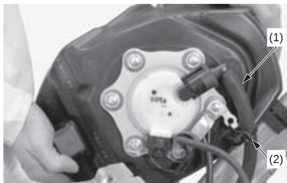
(1) manguera de suministro de combustible (2) abrazadera
