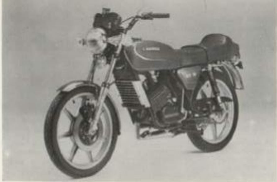
- LAVERDA 125 LZ - (175) 5 marce, telaio tubolare a doppia culla, raffreddamento a liquido, accensione elettronica, super cockpit con contagiri elettronico e contachilometri, lampeggiatore quadruplo.
