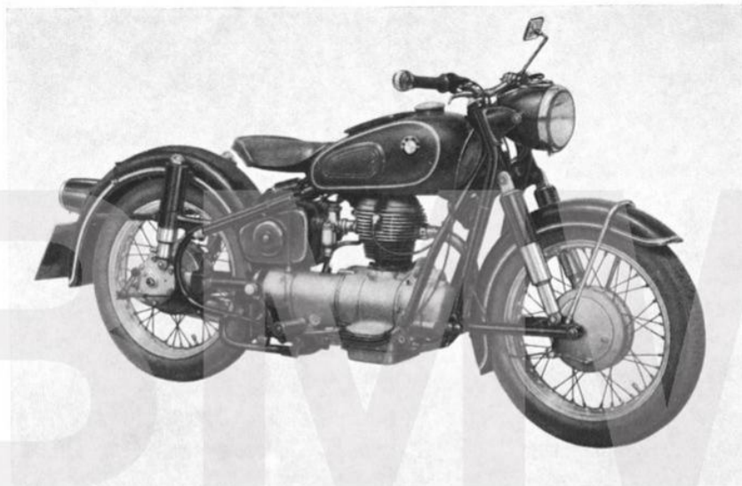
BMW R 27 mit Schwebemotor, Ansicht von rechts BMW R 27 with floating engine, seen from the right BMW R 27 avec moteur flottant, vue de droite
