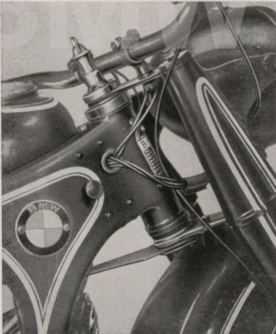
Bild 13. Steuerkopf und Steuerungsdämpfer
