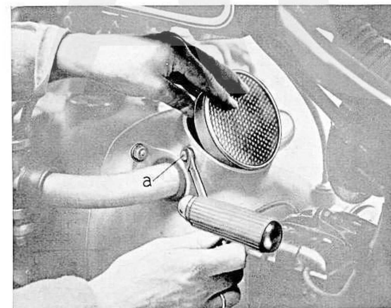
Abb. 11. Ausbau des Luftfilters am R 6-Motor
