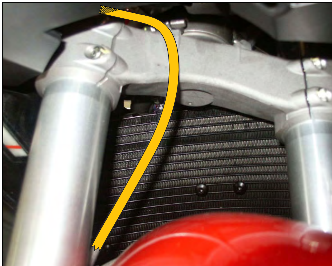
Posizionamento tubo freno anteriore su base di sterzo
