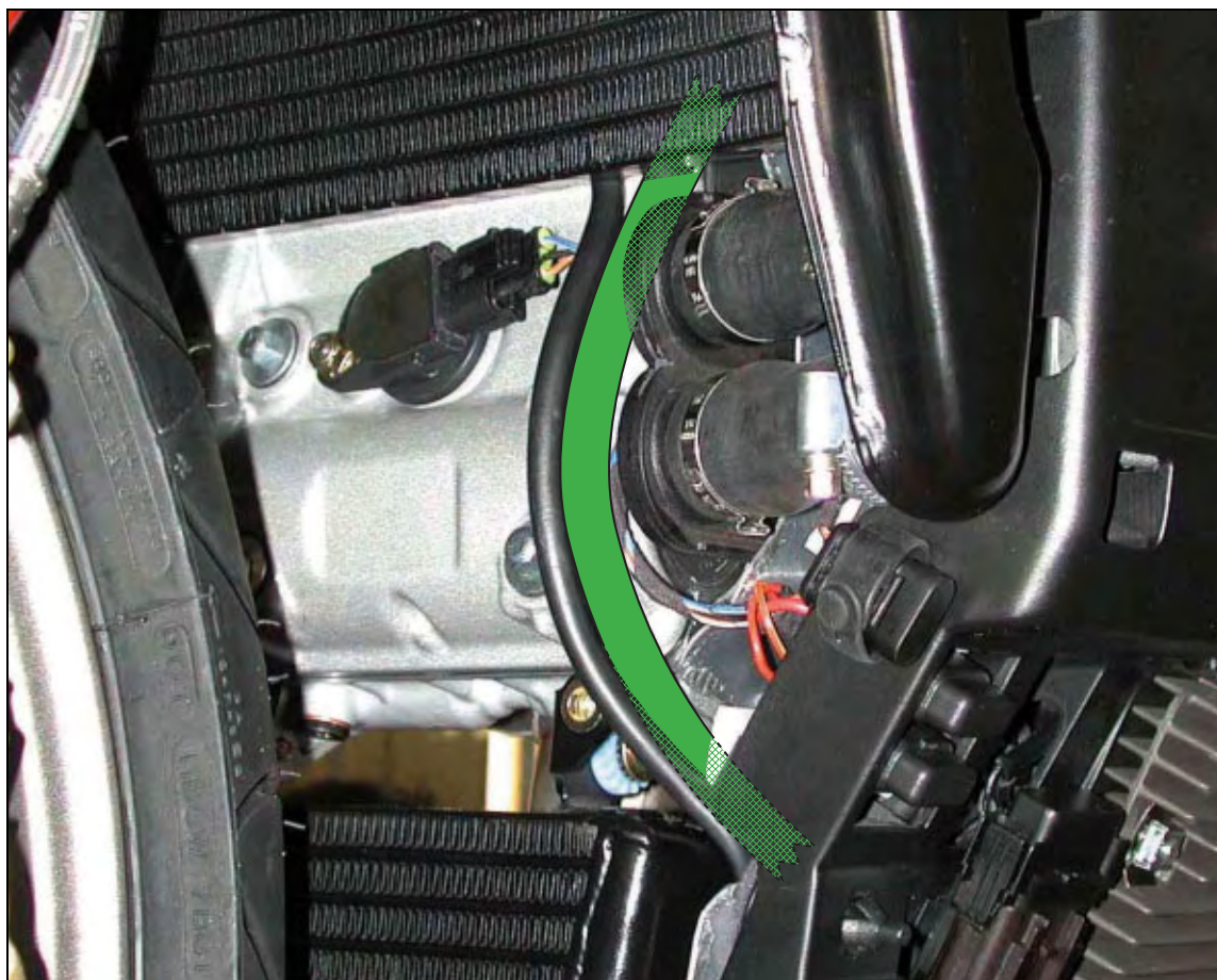
Posizionamento tubo drenaggio scatola filtro
