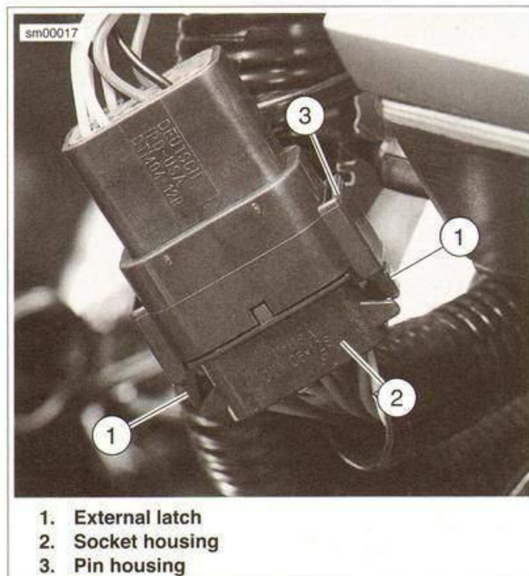
Figure A-10. Deutsch Connector
