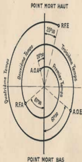
Diagramme de distribution de la 125 Terrot culbutée.
