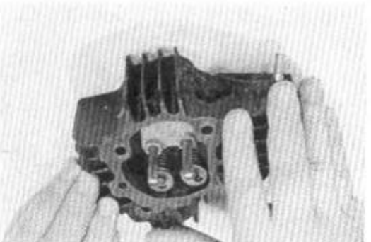
Afb. 55. — CONTROLE VAN DE CILINDERKOP OP DE VLAAPLAAT.
