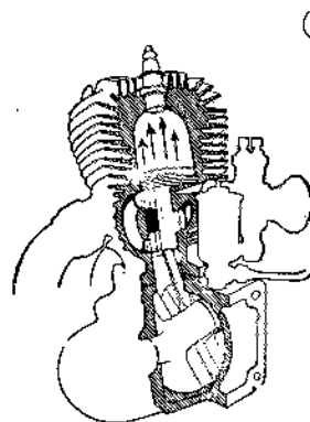
Abb. 5. Arbeitsschema des DKW-Zweitaktmotors mit Umkehrspülung.
