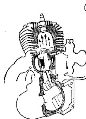
Abb. 5. Arbeitsschema des DKW-Zweitaktmotors mit Umkehrspülung.
