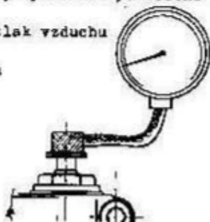
obr. 49 měření tlaku manometrem
