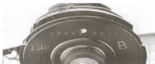
Bild 149 Eingeschlagene Lagerzapfen- und Hubzapfen-Kennzeich- nung
