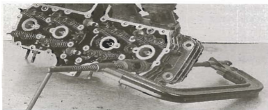
Bild 112 Ventilfederhalter im Einsatz
