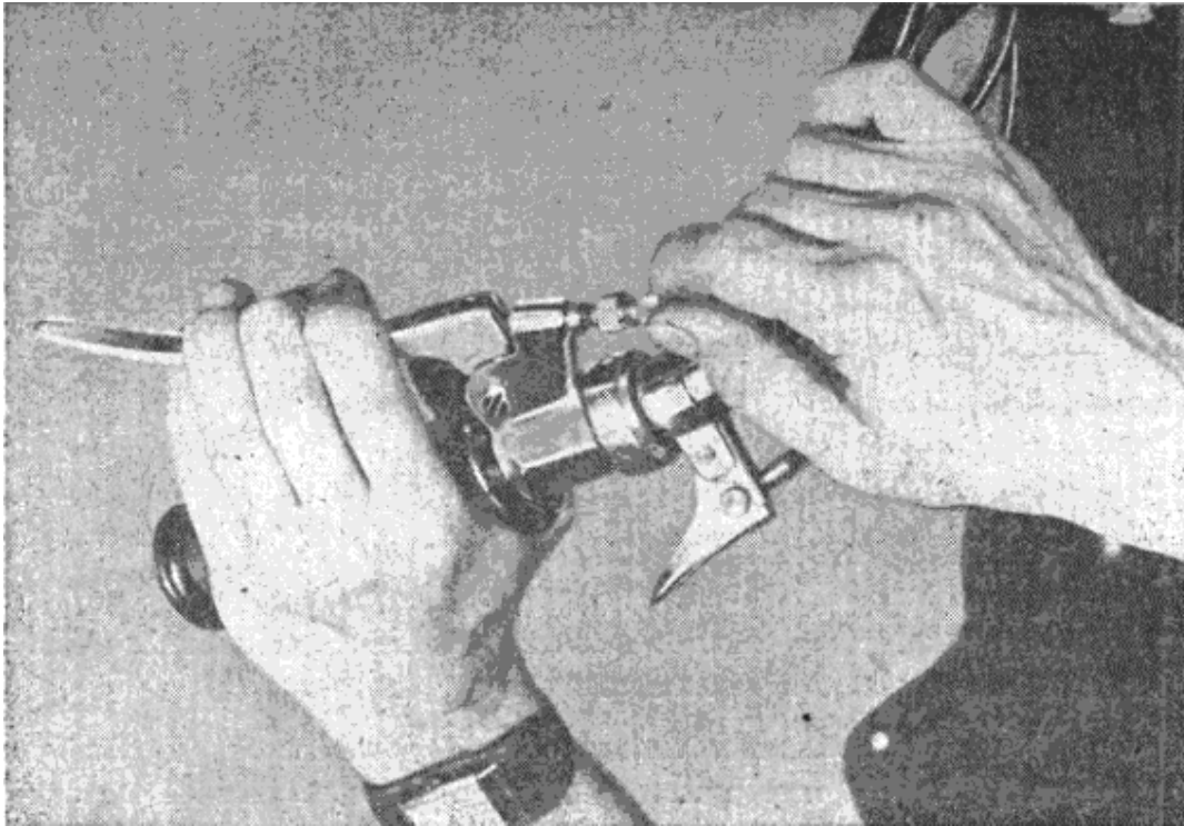
Obr. 15. Seřízení vůle lanka spojky.
