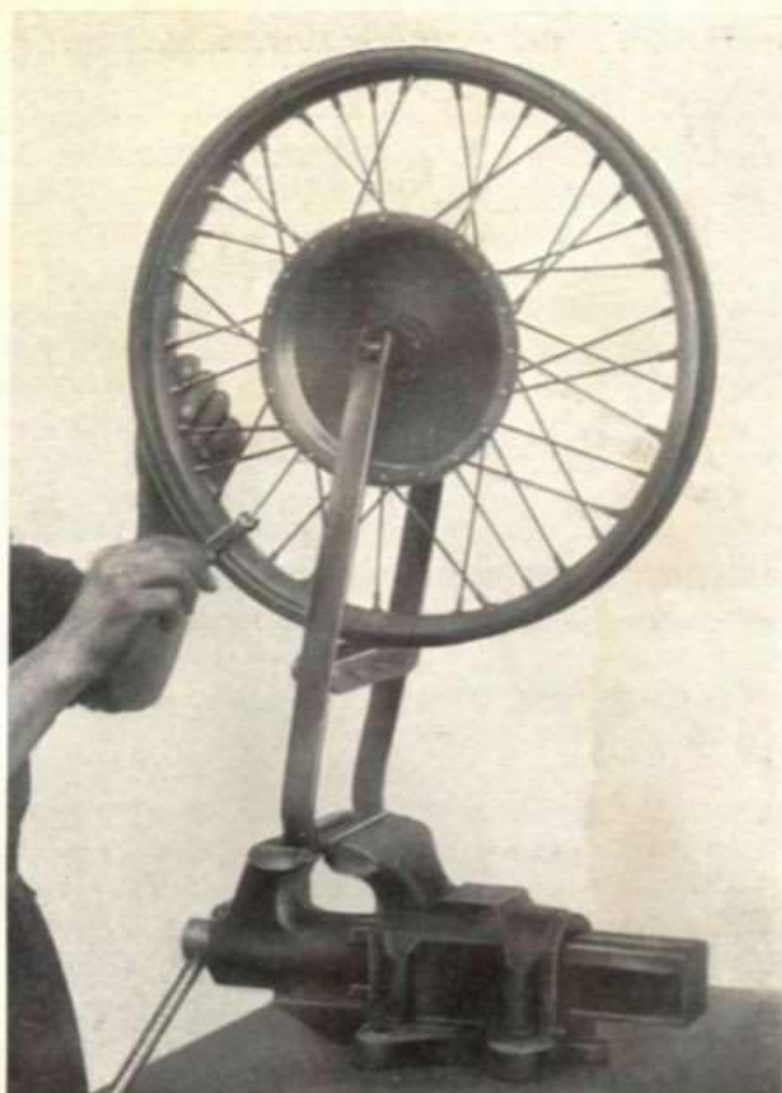
Fig. 140 -- A 46 Apparecchio e chiave per centrature ruote
