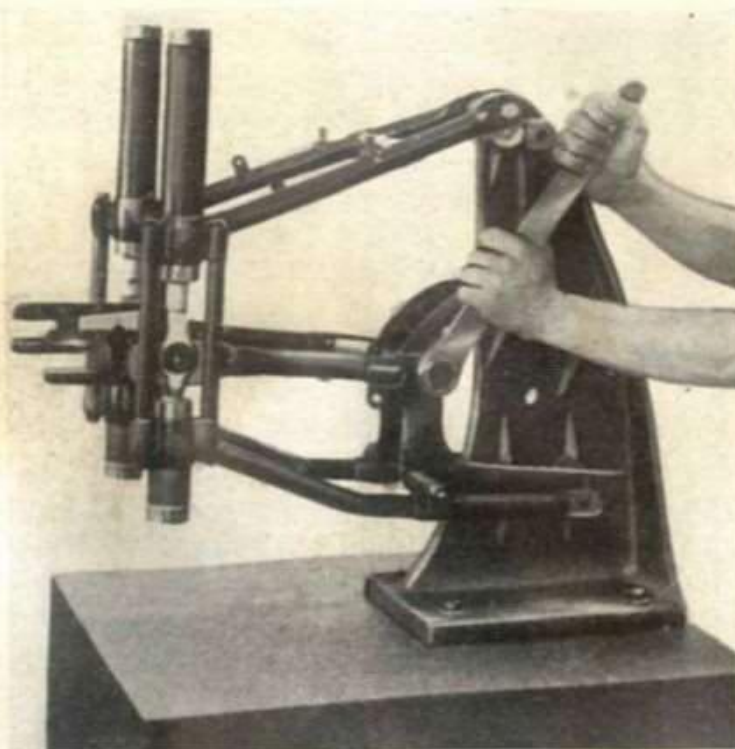
Fig. 122 - A 41 Chiave smontaggio dadi perno unione bracci elastici A 41 a Supporto smontaggio forcella posteriore elastica
