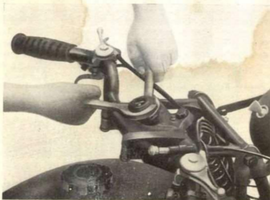
Fig. 118 - A 38-39 Chiavi speciali smontaggio sterzo
