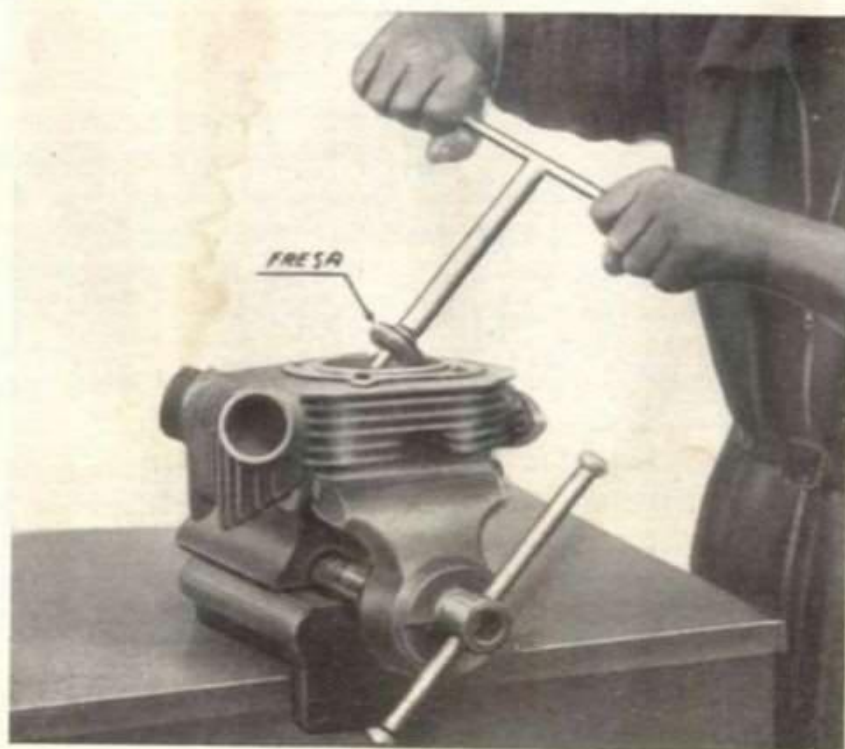
Fig. 42 - A 17 - 17 a Utensile a forma di fresa per ripassatura sedi valvole
