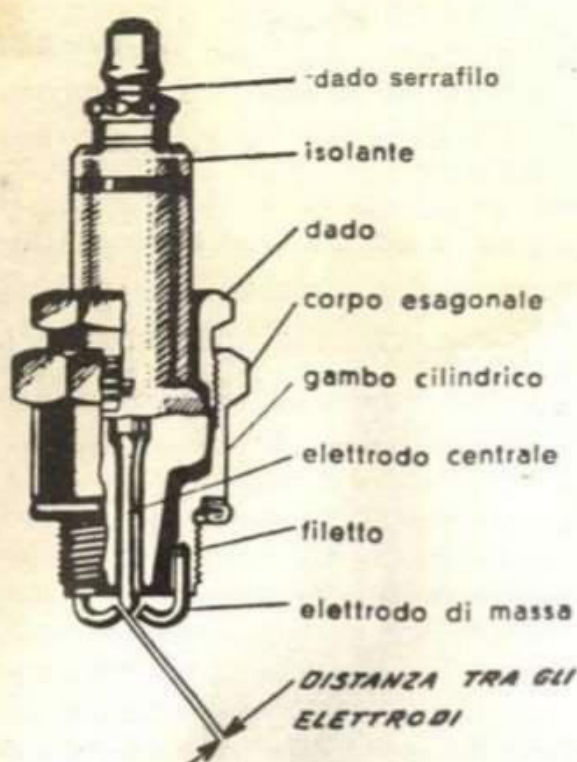
Sezione di una candela smontabile con isolante di porcellana
