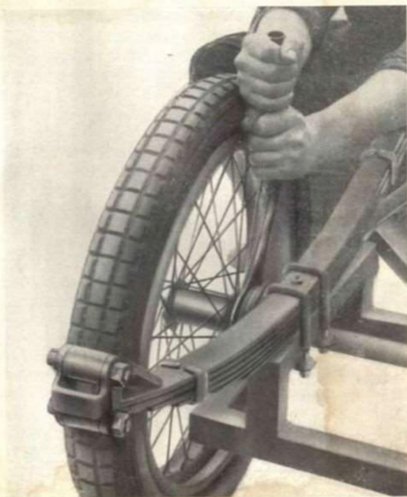
Fig. 102 - A 33 Chiave piatta sbloccaggio e smontaggio ruote
