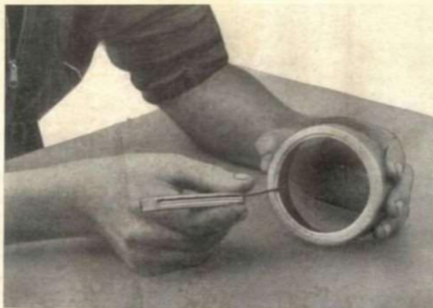
Fig. 50 - A 18-19 Anello di riscontro per anelli elastici
