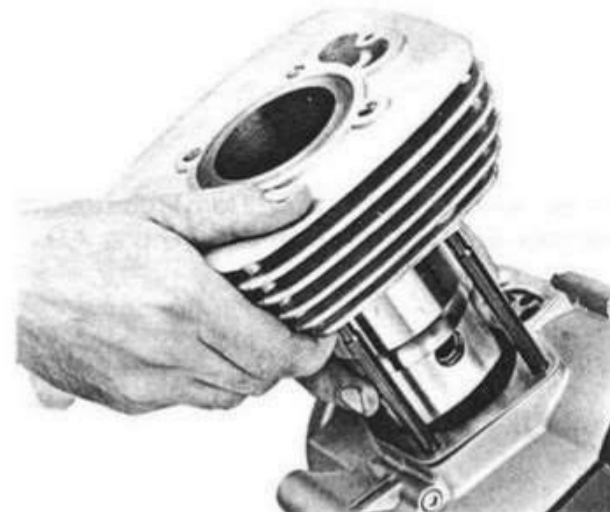
Fig. 44 Rimozione del cilindro Cylinder removal
