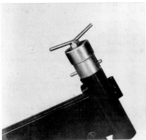
Slika 103. Vijak uvrstiti, pritegnuti i time ležaj izvući iz rama
