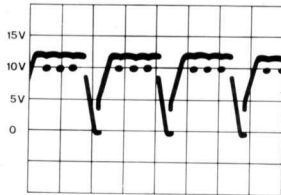
Slika 145. Prekid u pobudnoj diodi
