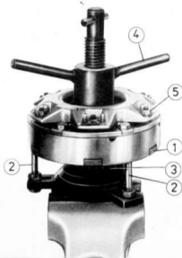
Slika 18. Demontaža spojke - kvačila
