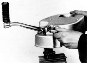
Slika 83. Pričvrstiti polugu nožnog pokretača
