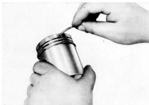
Slika 40. Čišćenje žlebova u klipu
