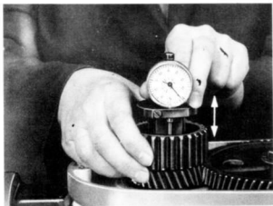
Slika 76. Izmeriti aksijalni zazor nažlebljene čaure
