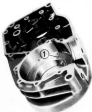
Slika 31. Kontrola kanala za ulje u kućištu
