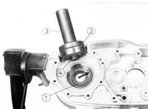
Slika 65. Desnu polutku kućišta pripremiti
