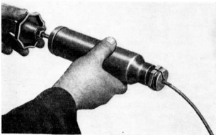
Slika 122. Žičana komanda upregnuta u napravu za podmazivanje
