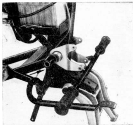
Slika 79. Njihalicu zadnjeg točka navući u pravcu strelice, pritisni prsteni su već skinuti
