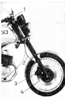
Slika 108. Raspored sastavnih delova diskovne koćnice
