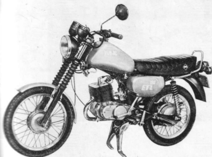
Slika 2. ETZ 125 150 sa dobošnom kočnicom u standardnoj izvedbi
