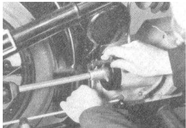
Bild 23. Nachstellen des Kupplungsbowdenzuges
