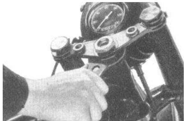
Bild 42. Lösen der Muttern zum Tragrohr
