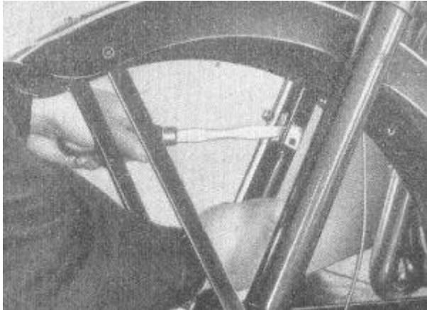
Bild 68. Vorderradschutzblech ausbauen (mittlere Schutzblechstreben aus den Halteschrauben herausheben)
