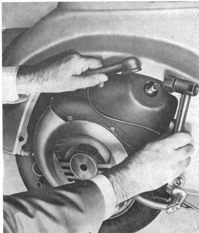
Fig. 9 - Dismantling spark - plug Fig. 9 - Desmontaje de la bujía
