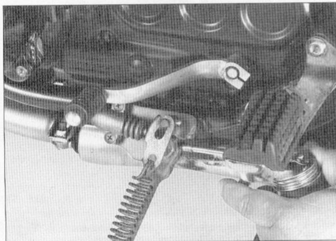
17.2e Lubricate the sidestand pivot point . . .
