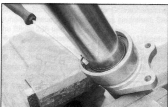
◀ Bild 236 Staubkappe aushebeln
