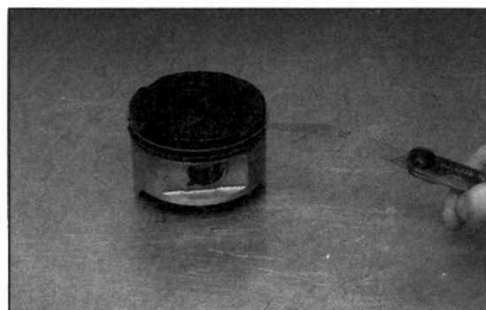
Bild 149 Kolbenringnut mit Fühlerlehre messen
