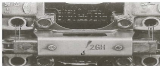
Bild 26 Nockenwellenmarkierungen mit Lagerdeckelmarkierungen ausrichten
