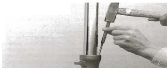
Bild 168 Tauchrohrbuchse und Wellendichtring eintreiben
