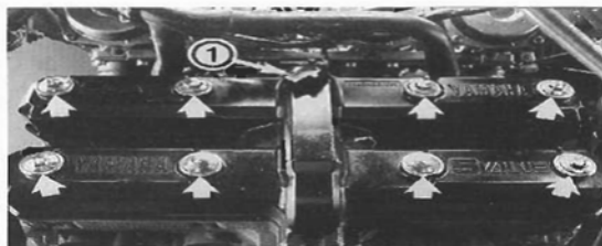
Bild 18 Ventildeckelschrauben 1 Stecker des Lüftermotors
