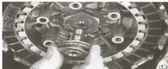
Bild 106 Ausrücklager mit O-Ring leicht gefettet einsetzen
