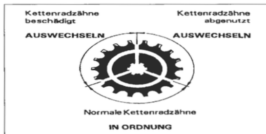
Bild 51 Kettenradverschleiss und -beschädigung
