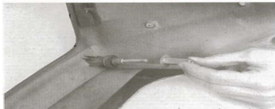
Bild 11 Spezialmuttern der Lampen- verkleidung lösen
