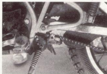
Bild 23 Antriebskette und vordere Kettenführung. Kettenschutz auch für unteres Kettenrum
