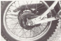
Bild 20 Bei Betätigung der Hinterradbremse soll der Winkel zwischen Bremsstange und der Verbindungslinie der beiden Drehpunkte des Bremsklüssels ein rechter sein
