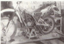
Bild 61 Die Sitzbank und der Kraftstofftank sind abgebaut
