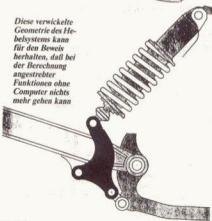
Bild 174 Prinzipdarstellung des Federungssystems für das Modell DT 80 LC/2 ab 1985
