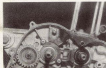
Bild 108 Das Ölleitblech wird von nur einer Schraube gehalten (Pfeil)
