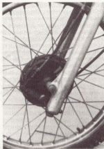
Bild 19 Bei Betätigung der Vorderradbremse bilden Bremsklüsel und Bowdenzug einen rechten Winkel
