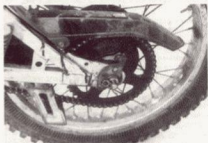
Bild 22 Kettenspannvorrichtung, Achsmuttersicherung und hintere Kettenführung
