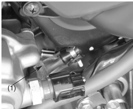
(1) Tubo de drenaje
