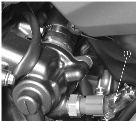
(1) Tubo de drenaje
