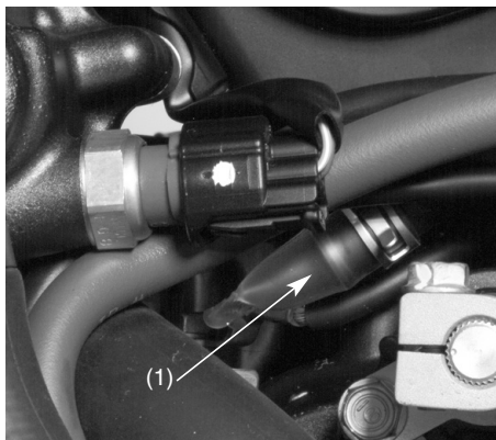
(1) Tubo de drenaje
