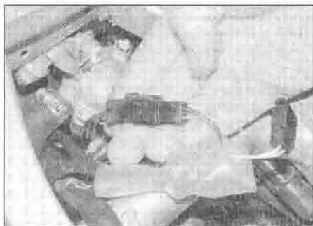
3.3a Fan wiring connector – XL600V
