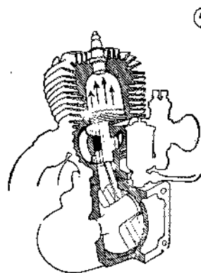
Abb. 5. Arbeitsschema des DKW-Zweitaktmotors mit Umkehrspülung.
