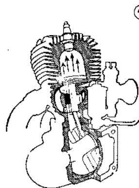
Abb. 5. Arbeitsschema des DKW-Zweitaktmotors mit Umkehrspülung.
