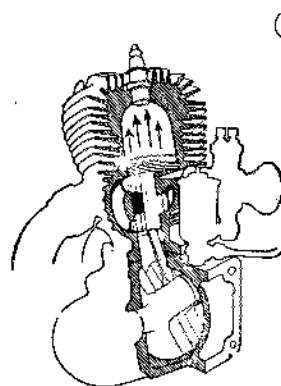
Abb. 5. Arbeitsschema des DKW-Zweitaktmotors mit Umkehrspülung.
